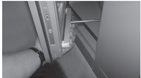
Kuulapää vapautuu lukituskantasta irrotusnapia painamalla.
